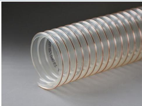
**Конструкция:** стенка изготовлена из 100% высококачественного полиуретана, устойчива к гидролизу и микробам (толщина стенки между спиралями около 0,9 мм), в стенку встроена спираль из пружинной стали с медным покрытием.
