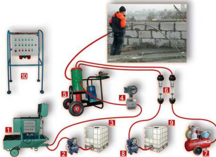
Рис.4. Мобильная установка «МК-1»: 1. растворосмесительная установка; 2. автоматический дозатор воды затворения; 9. емкости рабочего водного р-ра пенообразователя, 4. расходомер цементного р-ра, 5. поризатор, 6. ротаметры, 7. компрессор, 8. водяная станция
